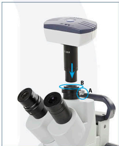
De EduBlue trinoculaire kop. Om de hoogte van de camera in te stellen; draai de schroef los (A), draai dan de bovenkant (B) naar onder of naar boven. Hierna de schroef weer vastdraaien
