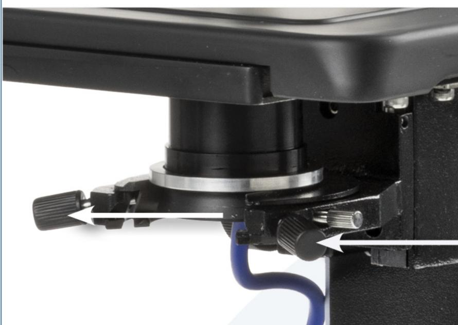
10. Pour utiliser l'objectif S100x à iris intégrée, vous devez également mettre une goutte d'huile d'immersion sur le couvre objet de la lame avec l'échantillon
