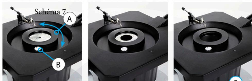
Tournez l'interrupteur du diaphragme à iris (A) pour changer l'ouverture de la lumière inférieure. L'ouverture du diaphragme à iris est de  $\varnothing 3\text{mm}$  -  $\varnothing 44\text{mm}$
