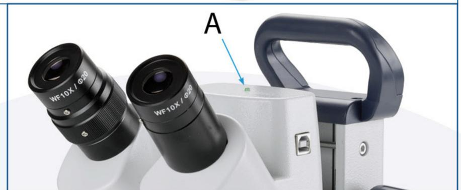
Les caméras numériques peuvent être utilisées en combinaison avec un microscope binoculaire standard. Retirez simplement l'oculaire (dévissez la vis de fixation) et placez la bague d'adaptation de la caméra à l'intérieur du tube de l'oculaire. Placez ensuite la caméra avec l'adaptateur à monture C monté dans le tube de l'oculaire. Focalisez l'image numérique avec les commandes du stéréomicroscope. Suivez le manuel fourni avec la caméra pour le fonctionnement de celle-ci
