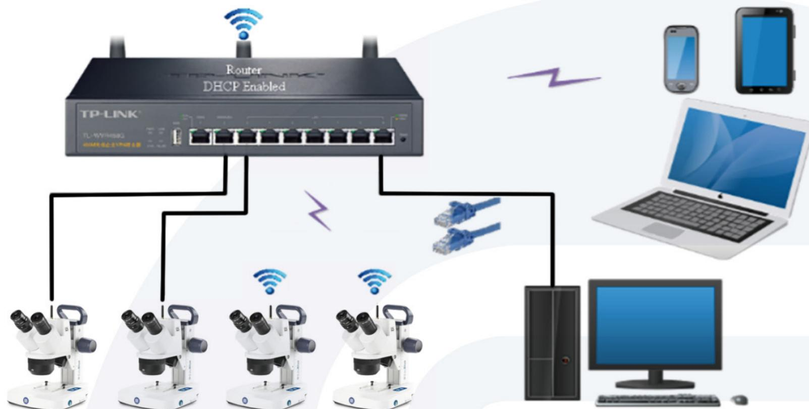
Connexion de plusieurs caméras au routeur via le port LAN pour l'application réseau
