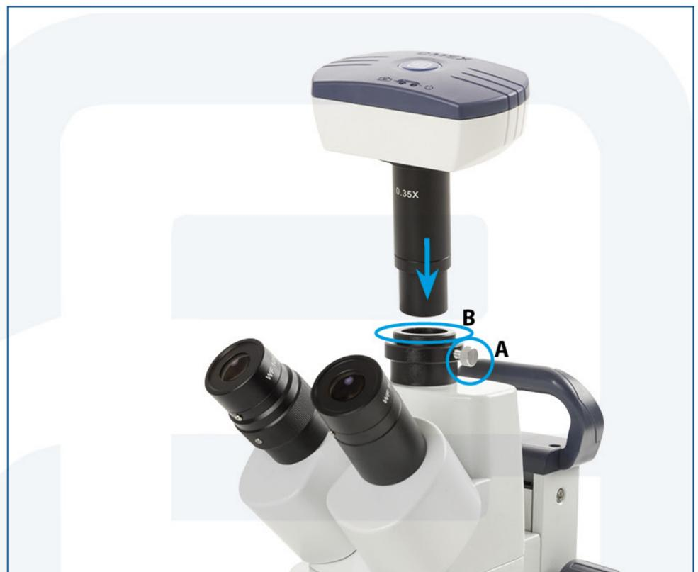
*La tête trinoculaire EduBlue. Pour régler la hauteur de la caméra, desserrez la vis (A), puis tournez la partie supérieure (B) vers le haut ou vers le bas. Resserrer la vis*
