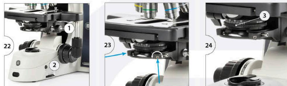
Le diaphragme d'ouverture doit être utilisé pour régler l'ouverture numérique et non pour régler la luminosité de l'image. Lorsque le diaphragme d'ouverture est ouvert à 70 ~ 80% de l'ouverture de l'objectif, la position idéale est atteinte
