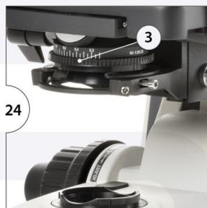
Le diaphragme d'ouverture doit être utilisé pour régler l'ouverture numérique et non pour régler la luminosité de l'image. Lorsque le diaphragme d'ouverture est ouvert à 70 ~ 80% de l'ouverture de l'objectif, la position idéale est atteinte
