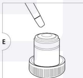
*Veillez noter que le nettoyage des surfaces optiques indiqué dans cette instruction s'applique uniquement aux surfaces externes des objectifs, oculaires, filtres et condensateurs. Les surfaces internes doivent toujours être réalisées par votre distributeur de microscopes Euromex*
