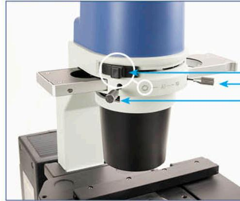
Las clavijas de centrado (C) se pueden introducir por los orificios de la carcasa de la lámpara del condensador hasta alcanzar los orificios de los tornillos (resp. D y E)
