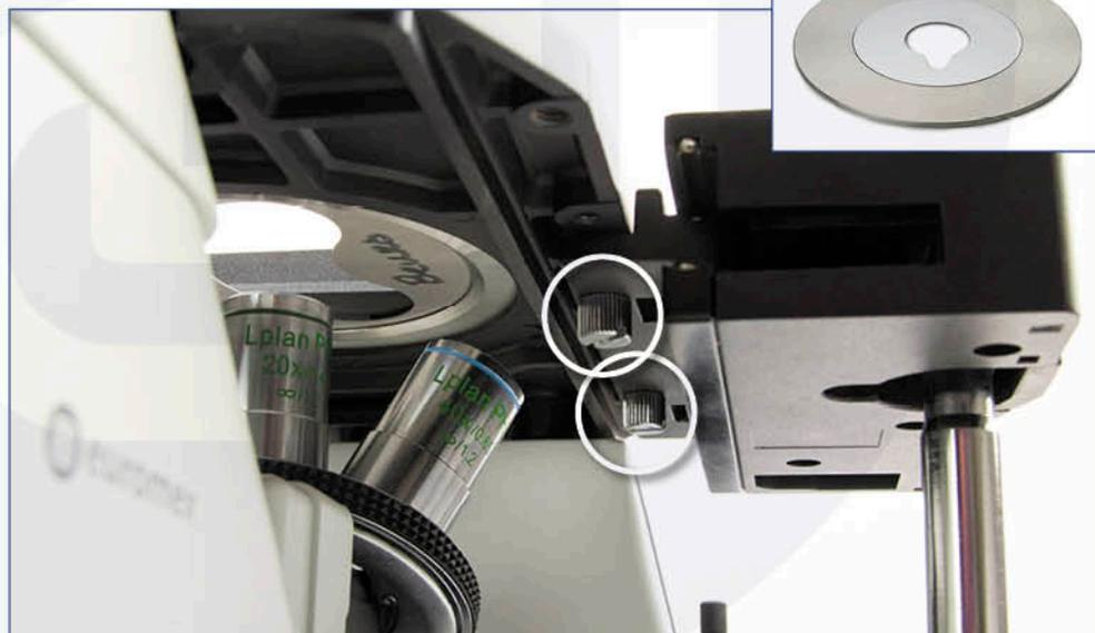
Montaje de la platina mecánica
