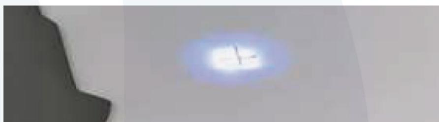
Utilice los tornillos (**B1 y B2**) de la carcasa de la lámpara para mover el haz directo ligeramente fuera del centro de la cruz
