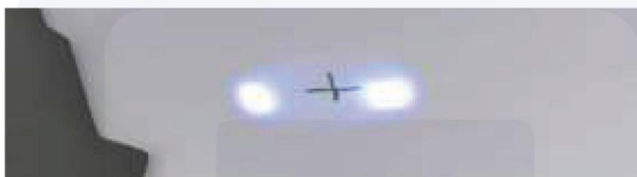
Para mover el haz de luz directo utilizar los tornillos de ajuste horizontal y vertical al lado de la carcasa de la lámpara (**B1 and B2**)
