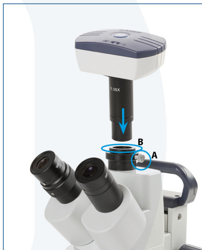
Cabezal trinocular EduBlue. Para ajustar la altura de la cámara, afloje el tornillo (A), luego gire la parte superior (B) hacia arriba o hacia abajo. Apretar el tornillo
