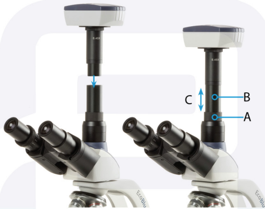
EcoBlue trinocular con la cámara en el tubo trinocular
