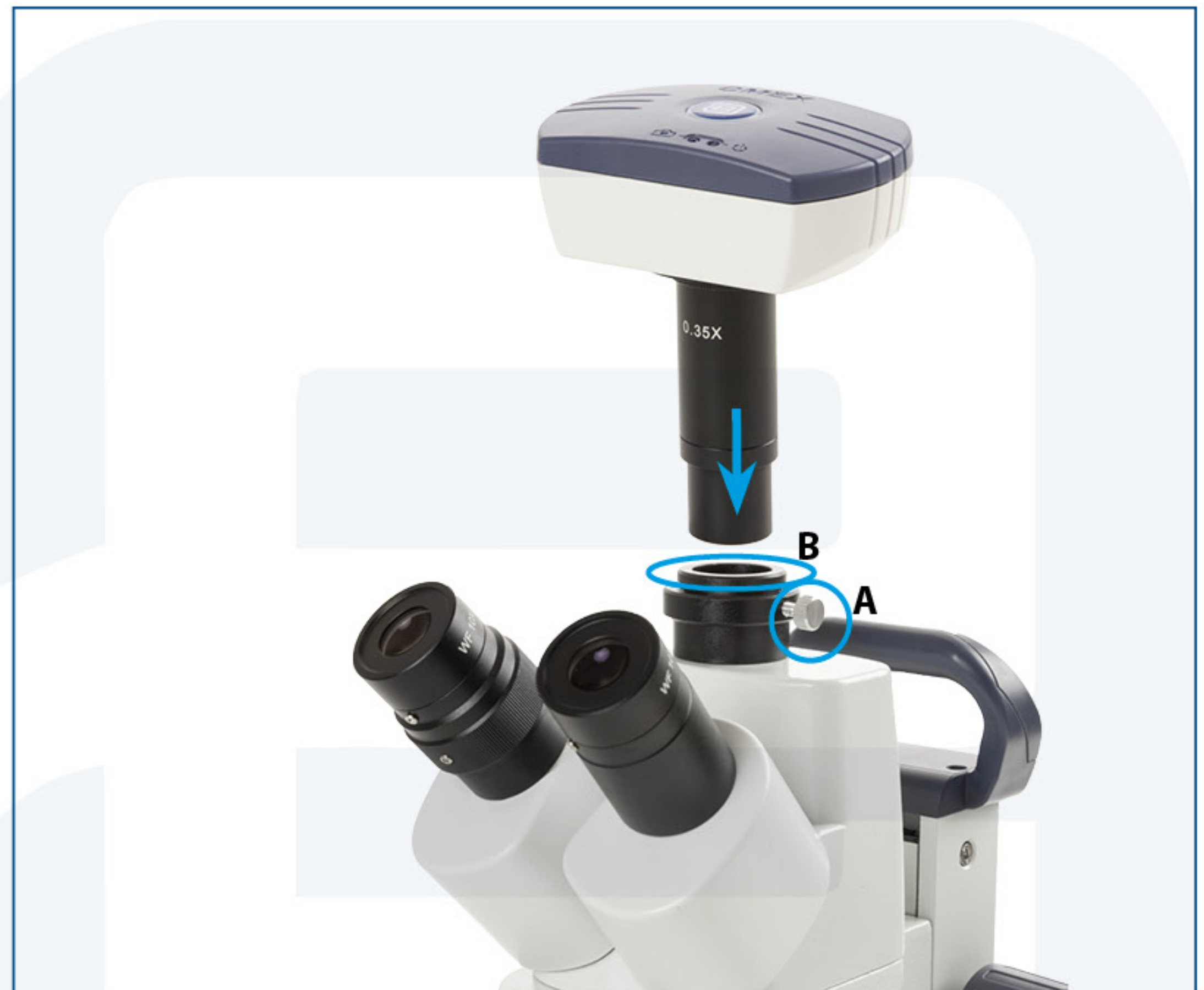
Der EduBlue Trinokularkopf. Um die Höhe der Kamera einzustellen, lösen Sie die Schraube (A) und drehen Sie dann den oberen Teil (B) nach oben oder unten. Ziehen Sie die Schraube wieder an
