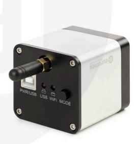
Im WiFi-Modus: Schließen Sie das USB-Kabel an den PWR/USB-Anschluss der Kamera an und verbinden Sie die andere Seite mit dem Stromanschluss. Die Kamera funktioniert nun wie eine WiFi-Kamera und verwendet die ImageFocus Alpha PC-Software oder die ImageFocus Alpha-App
